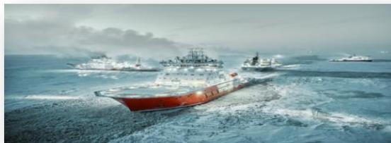
В 2015 г. был подписан контракт на строительство портового ледокола «Обь» для проекта «Ямал СПГ» по заказу ФГУП «Атомфлот». Портовый ледокол проекта Aker ARC124 мощностью около 12 МВт с инновационной движительной системой имеет ледовый класс Icebreaker7. Судно было передано заказчику в 2019 г.
