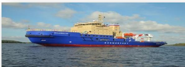
В апреле 2015 г. завод подписал контракт на строительство двух многоцелевых ледокольных судов обеспечения мощностью 22 МВт. Суда были построены по новейшему проекту компании Aker Arctic под ледовый класс Icebreaker 8. Оба судна были переданы
