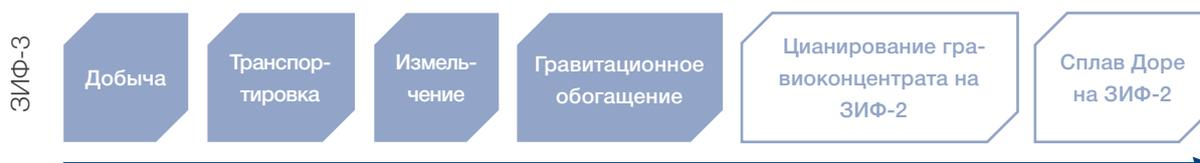
Отработка элювиально-делювиальной россыпи месторождения Голец Высочайший осуществляется открытым способом экскаваторно-автотранспортным комплексом с вывозом песков на промывочный комплекс.
